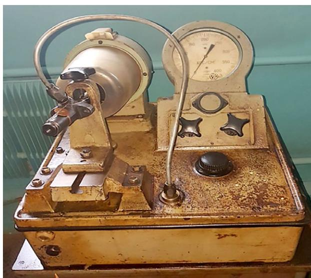
Рис. 5. Прибор КИ-3333 для испытания и регулировки форсунок.
