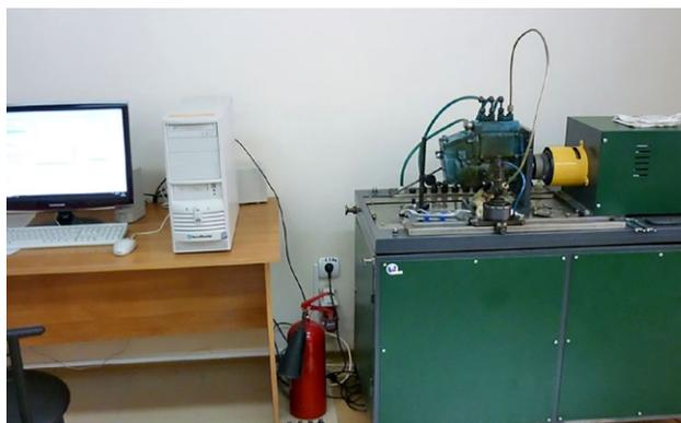
Рис. 4. Стенд КИ-35478 для испытания дизельных форсунок.
