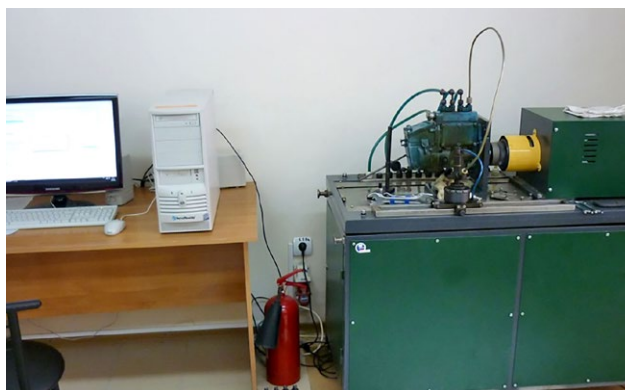
Рис. 4. Стенд КИ-35478 для испытания дизельных форсунок. Fig. 4. The KI-35478 bench for diesel injectors testing.
