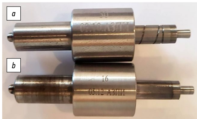
Рис. 2. Распылители форсунки ФД-22 с (а) модернизированной и (б) серийной иглой.
