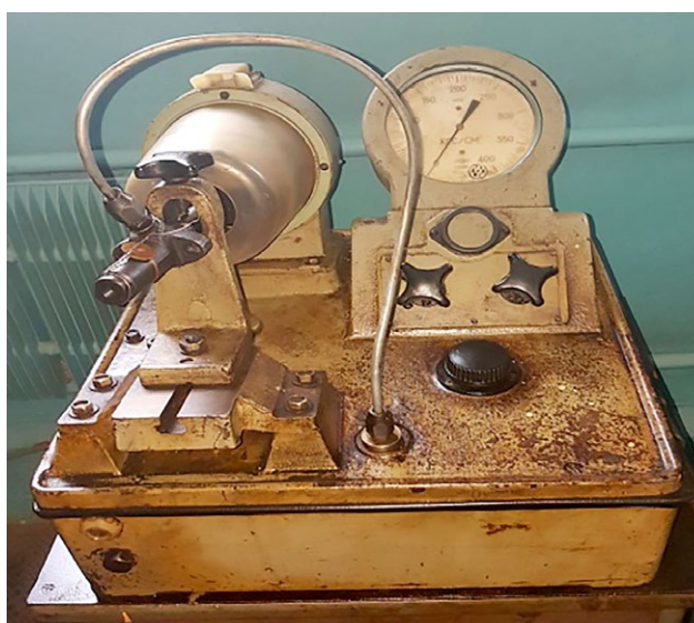
Рис. 5. Прибор КИ-3333 для испытания и регулировки форсунок. Fig. 5. The KI-3333 device for nozzles testing and adjusting.
