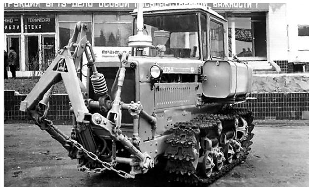
Рис. 9. Модификация трактора ДТ-75Н для возделывания кукурузы по интенсивным технологиям.
