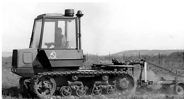
**Рис. 10.** Экспериментальный трактор ВТГ-150 с бесступенчатой гидростатической трансмиссией.
