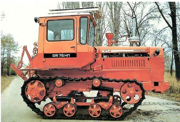
**Рис. 3.** Пахотно-пропашной трактор ДТ-75НП с установленными повысителями агропросвета на гусеницах шириной 240 мм.
