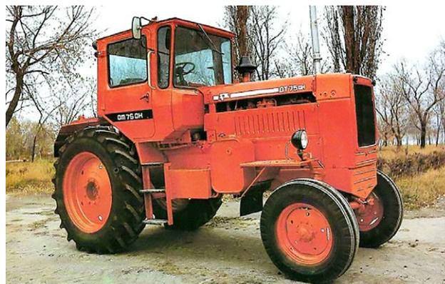
**Рис. 11.** Колёсный универсально-пропашной трактор ДТ-75ДК.
