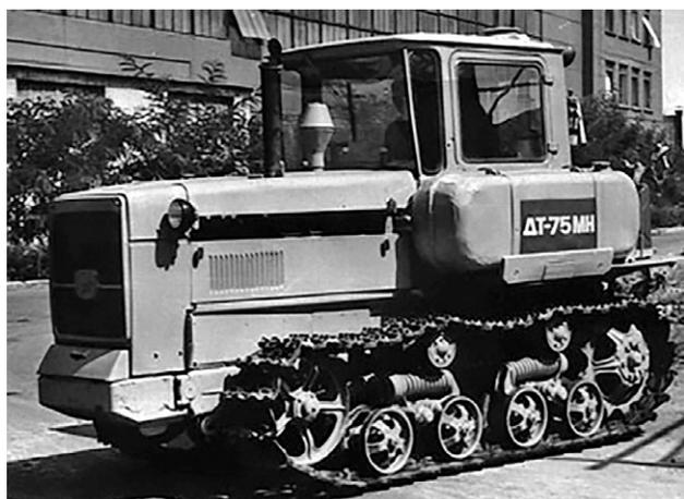
**Рис. 14.** Опытный образец трактора ДТ-75МН с дизелем А-41Т.
