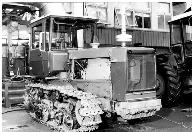
**Рис. 13.** Опытный образец трактора на базе ДТ-75В с дизелем воздушного охлаждения ВгМЗ.
