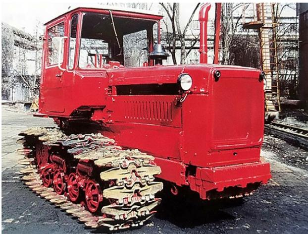
**Рис. 2.** Торфяной трактор ДТ-75ДТ.
