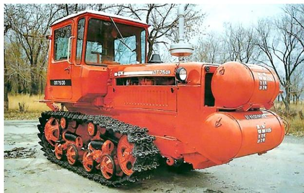
**Рис. 12.** Газодизельный трактор ДТ-75ДА, опытный образец.
