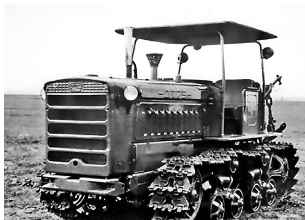
**Рис. 5.** Экспортно-тропический вариант трактора ДТ-75 с тентом.
