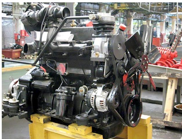
**Рис. 16.** Финский дизель SISU 44DTA перед установкой на трактор ВТ-90В в сборочном цехе №1 ВГТЗ.
