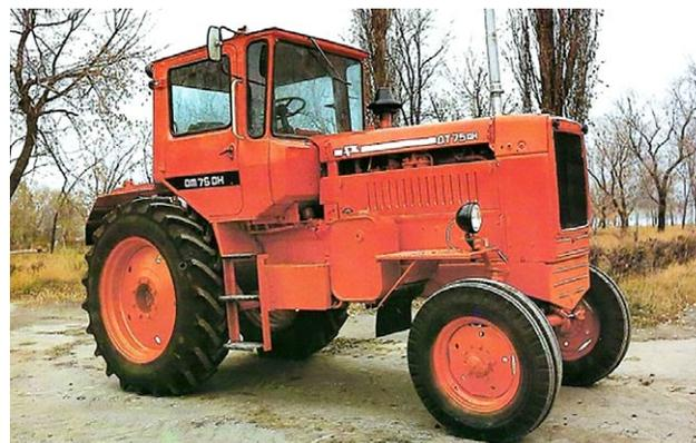
**Рис. 11.** Колёсный универсально-пропашной трактор ДТ-75ДК.
