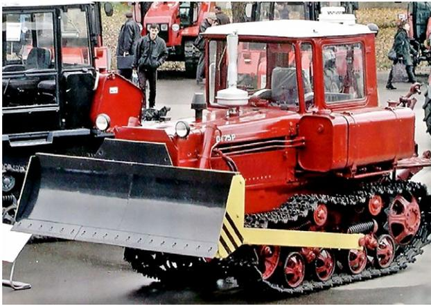
**Рис. 1.** Трактор ДТ-75РМ с дизелем РМ-80. Внешнее отличие: воздухозаборник дизеля расположен перед выхлопной трубой с глушителем.
