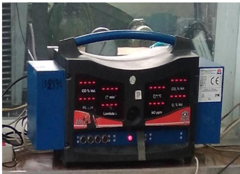
**Рис. 2.** Газоанализатор MGT-5 МАНА.
