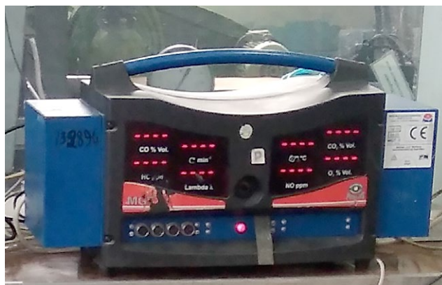
Рис. 2. Газоанализатор MGT-5 MAHA. Fig. 2. The MGT-5 MAHA gas analyzer.
