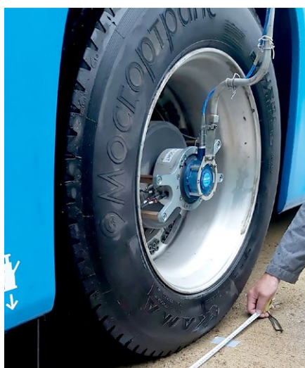
Рис. 1. Тензометрические колёса Kistler-Rim RoaDyn. Fig. 1. Kistler-Rim RoaDyn strain gauge wheels.
