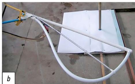
**Рис. 2.** Схема (а) и опытный образец (b) поворотного устройства: 1 — щуп; 2 — щелевой распылитель; 3 — пружина.
