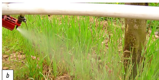
Рис. 3. Схема (а) и опытный образец (b) щелевого распылителя: 1 — воздушная трубка; 2 — пневматическая проточная камера; 3 — питательная трубка распылителя. Fig. 3. The layout (a) and the prototype (b) of the slot atomizer: 1 — an air tube; 2 — a pneumatic flow chamber; 3 — an atomizer feeding tube.
