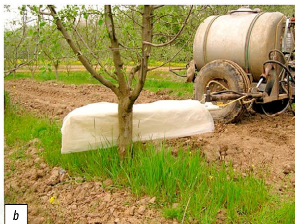
Рис. 1. Схема (а) и опытный образец (б) опрыскивателя с щелевым распылителем и поворотным устройством: 1 — рама; 2 — бак; 3 — щелевой распылитель; 4 — компрессор; 5 — воздушный коллектор; 6 — поворотное устройство; 7 — фартук.
