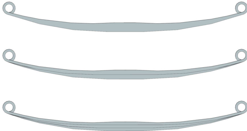
Рис. 3. Построенные с учетом топологической оптимизации 3D-модели рессор.
