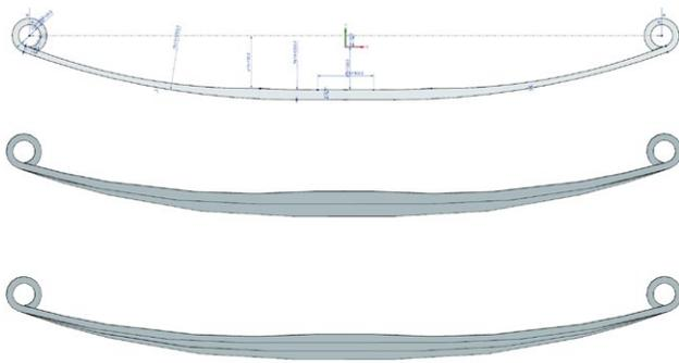
**Рис. 3.** Построенные с учетом топологической оптимизации 3D-модели рессор.
