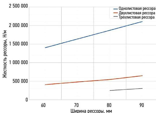
**Рис. 10.** Зависимости жёсткости рессоры от ширины рессоры в поперечном сечении её центральной части.
