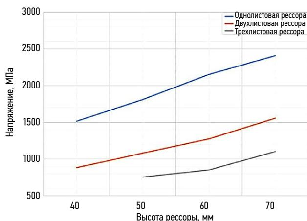
**Рис. 9.** Зависимости возникающих в рессоре максимальных напряжений от высоты рессоры в поперечном сечении её центральной части.
