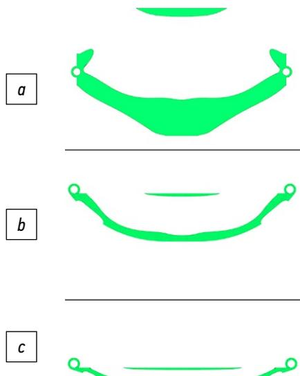
**Рис. 2.** Итерации топологической оптимизации: *a)* первая итерация топологической оптимизации; *b)* вторая итерация топологической оптимизации; *c)* третья итерация топологической оптимизации.
