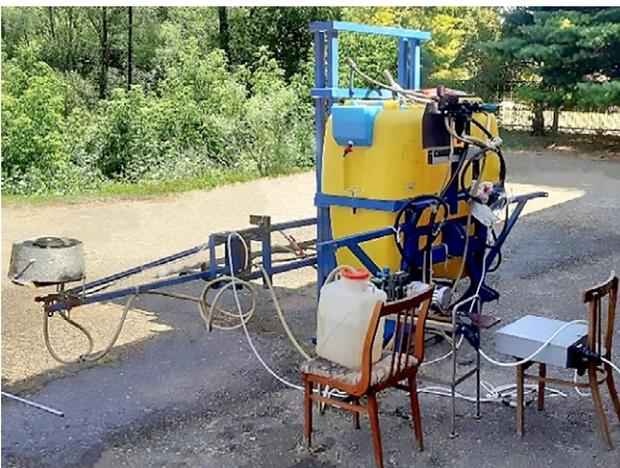
**Рис. 12.** Фрагмент работы пневмогидравлических устройств в составе малогабаритного опрыскивателя.
