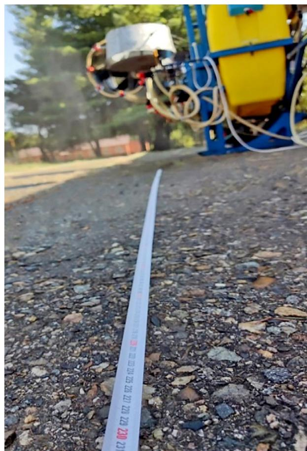
**Рис. 13.** Фрагмент определения ширины опрыскивания опрыскивателем с двумя пневмогидравлическими распылителями.
