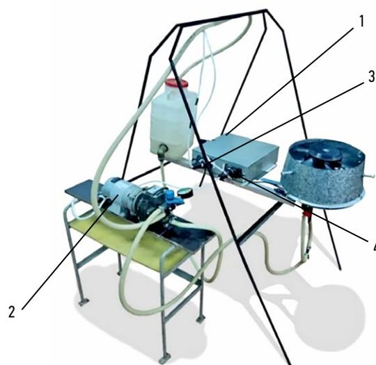
**Рис. 8.** Общий вид лабораторной установки для определения ширины распыления капельной жидкости пневмогидравлическим устройством при исследовании комбинированного метода защитного опрыскивания сельскохозяйственных культур: 1 — преобразователь напряжения 12 В; 2 — насос 12 В для подачи жидкости (воды) из емкости по шлангам к щелевым распылителям; 3, 4 — разъемы и переключатели.
