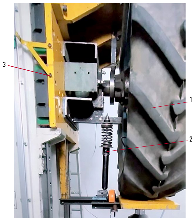
Рис. 8. Установка пневматического колеса с пружинно-гидравлической миниподвеской на динамическом гидропульсаторном стенде: 1 — пневматическое колесо от задней оси трактора МТЗ-82; 2 — пружинно-гидравлическая миниподвеска с опорным роликом; 3 — подвижная плита с грузами.
