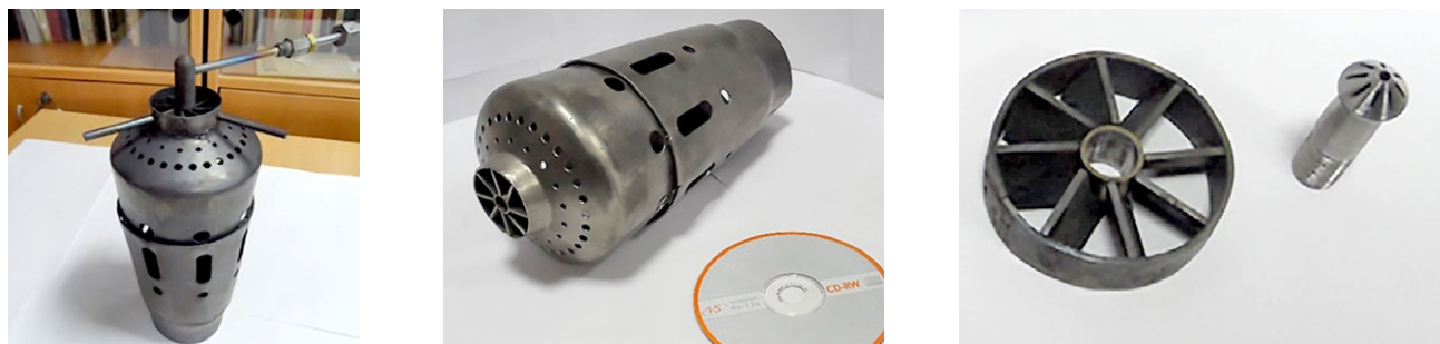
Рис. 3. Жаровая труба с форсункой и завихрителем трубчатой, индивидуальной камеры сгорания.
