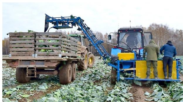
**Рис. 9.** Обслуживание многовариантного капустоуборочного комбайна за столом доработки двумя рабочими.
