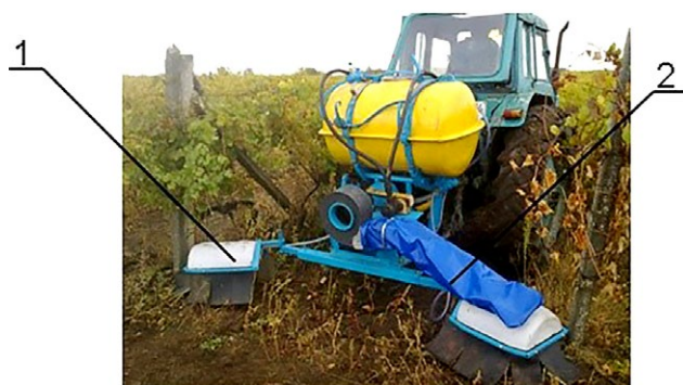
Рис. 3. Опрыскиватель ОНГВ-500: 1 — секция без воздушно-го опрыскивания; 2 — секция с принудительным воздушным опрыскиванием.
