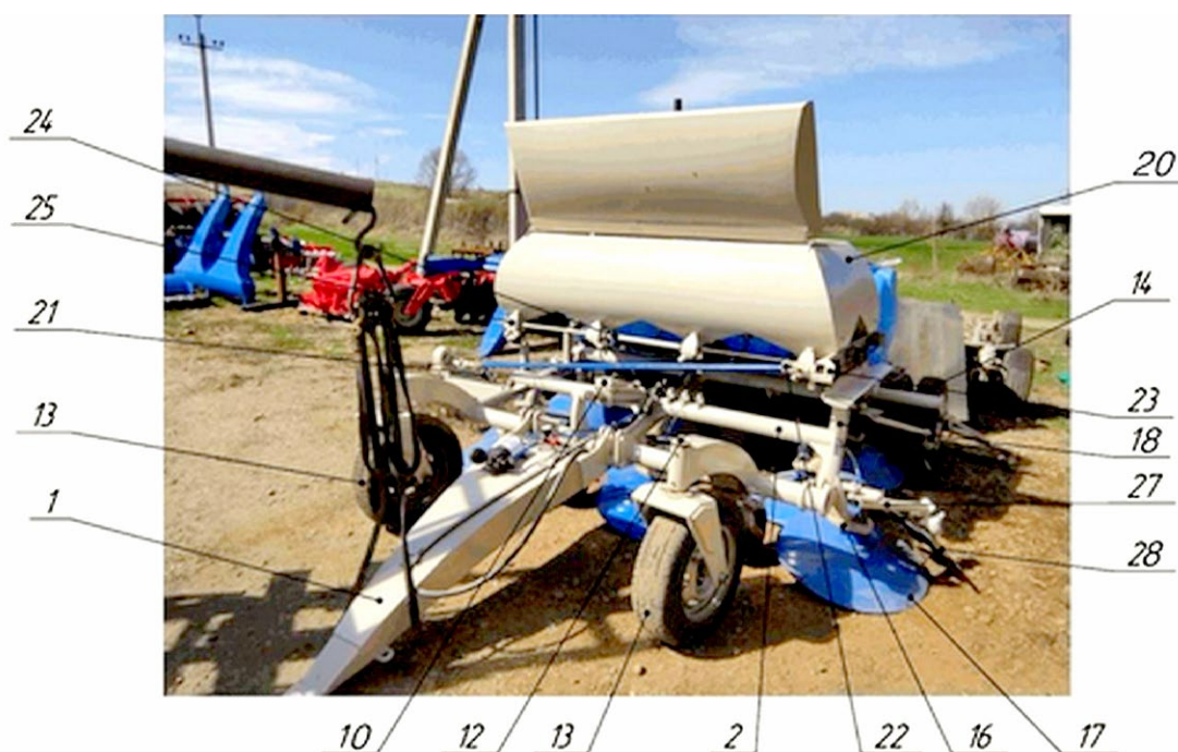
Рис. 3. Общи вид физического прототипа разработанной сеялки-культиватора: 1 — сцепка; 2 — рама; 10 — гидроцилиндры; 12 — опора; 13 — парные колеса; 14 — колёса; 16 — лапы; 17 — диски; 18 — стойки; 20 — бункер; 21 — диск привода высевяющего аппарата; 22 — карданный вал; 23 — редуктор; 24 — шестигранный вал привода высевяющих аппаратов; 25 — высевяющие аппараты; 27 — стойки, 28 — разрыхлители.
