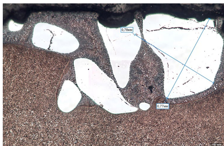
Рис. 3. Карбиды вольфрама в микроструктуре наплавки на поверхности детали, \times 90 .
