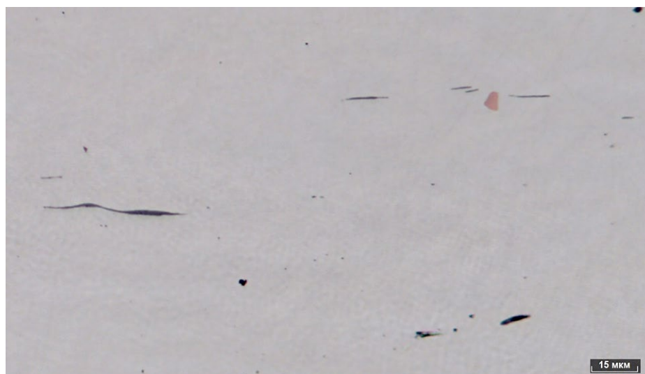
Рис. 6. Неметаллические включения в металле детали, \times 800 . Fig. 6. Non-metallic inclusions in the metal of the detail, \times 800 .
