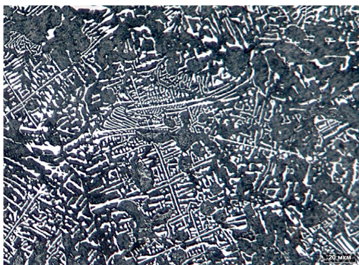
Рис. 2. Микроструктура вольфрамовой основы наплавленного слоя на поверхности детали, \times 500 .
