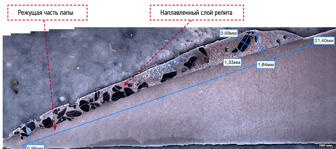
Рис. 1. Макроструктура режущей кромки культиваторной лапы после наплавки на неё релита с последующей закалкой.
