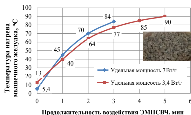
Рис. 4. Динамика нагрева измельченных куриных мышечных желудков в ЭМП СВЧ при разных удельных мощностях.
