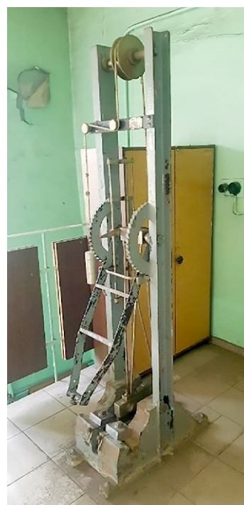
Рис. 8. Испытательное оборудование: a — универсальная испытательная машина Zwick/Roell серии Allround Z100; b — маятниковый копер МК-30.
