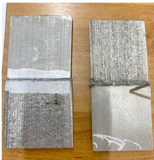
Рис. 3. Сваренные пластины из напечатанного АМг5 и сплава 6082Т4 (слева) и напечатанного АМг5 и листового АМг5 (справа). Fig. 3. The welded plates: the printed AMg5 alloy + the 6082T4 alloy (left) and the printed AMg5 alloy + the sheet of the AMg5 alloy (right).
