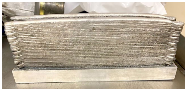
Рис. 2. Напечатанная пластина из сплава АМг5. Fig. 2. The aluminum plate printed of the AMg5 alloy.
