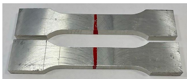
Рис. 3. Сваренные пластины из напечатанного АМг5 и сплава 6082Т4 (слева) и напечатанного АМг5 и листового АМг5 (справа). Fig. 3. The welded plates: the printed AMg5 alloy + the 6082T4 alloy (left) and the printed AMg5 alloy + the sheet of the AMg5 alloy (right).
