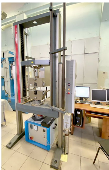
Рис. 8. Испытательное оборудование: a — универсальная испытательная машина Zwick/Roell серии Allround Z100; b — маятниковый копер МК-30.
