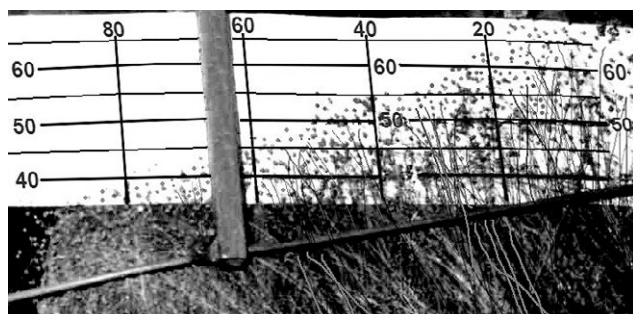
Рис. 4. Смещение \Delta ленты льна в направлении наклона стола. Fig. 4. The flux strip displacement \Delta in the direction of the tilt of the table.
