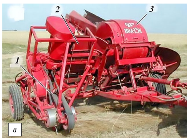
Рис. 1. Подборщик-очёсыватель лент льна: a — вид спереди; b — вид на ориентирующее устройство: 1 — подборщик; 2 — ориентирующее устройство; 3 — очёсывающий аппарат.
