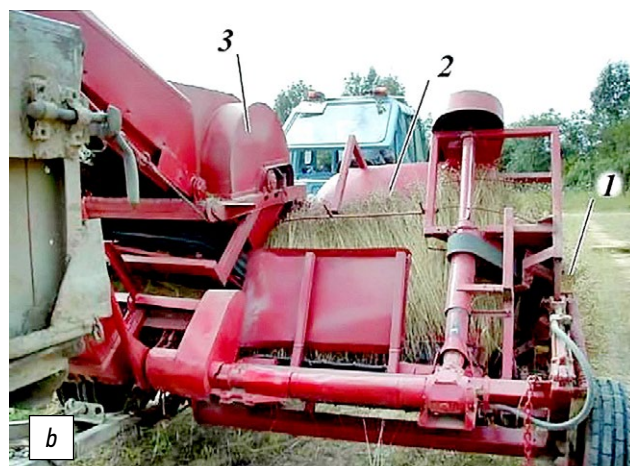
Рис. 1. Подборщик-очёсыватель лент льна: a — вид спереди; b — вид на ориентирующее устройство: 1 — подборщик; 2 — ориентирующее устройство; 3 — очёсывающий аппарат.
