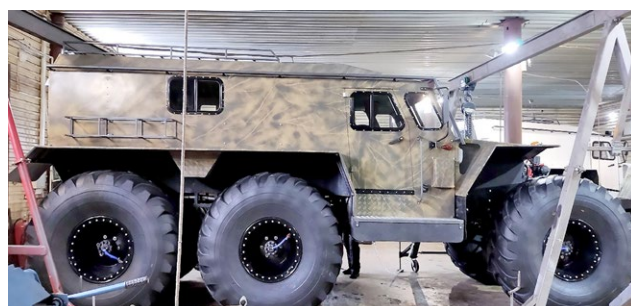
Рис 1. Снегоболотоход на шинах сверхнизкого давления ХИЩНИК-3930.
