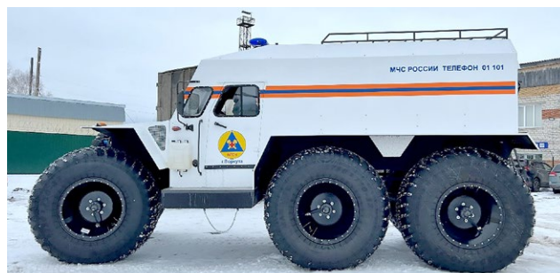
Рис 2. Снегоболотоход на шинах сверхнизкого давления ХИЩНИК-3940.
