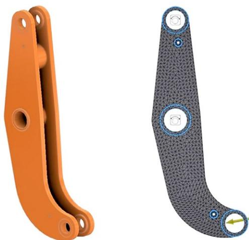
**Рис. 6.** Коромысло в сборе и подготовленная для расчёта боковина.
