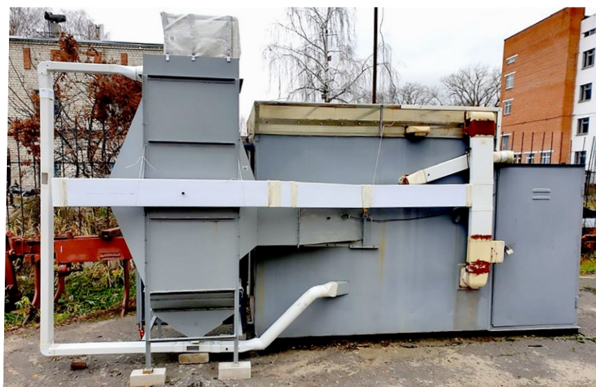
Рис. 1. Сушилка аэродинамического нагрева с комбинированным теплообменником и дополнительным модулем в виде сушильной шахты для зерна.
