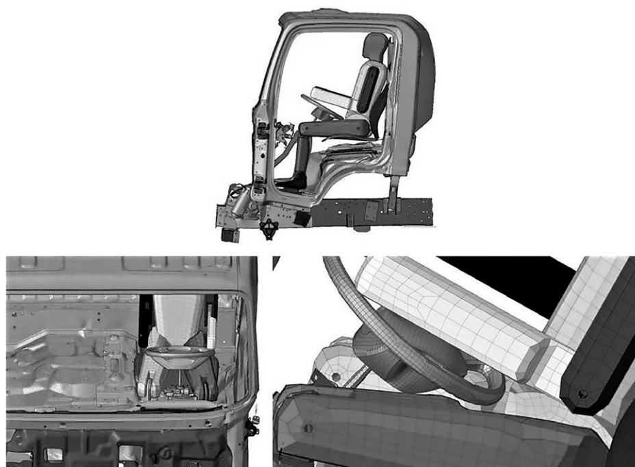
Рис. 15. Размещение манекена в кабине с низкой крышей. Испытание А, энергия удара 55 кДж. Fig. 15. Placing the dummy in a low-roofed cabin. The test A, the impact energy is 55 kJ.
