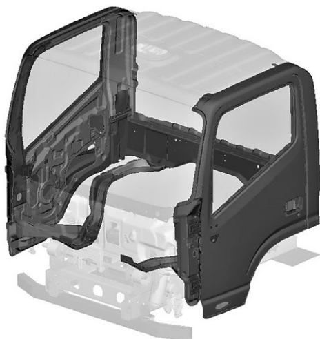
Рис. 22. Элементы каркаса кабины, изменённые и добавленные в Модель 1.
