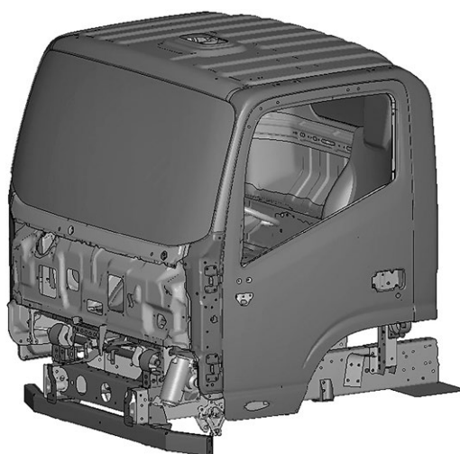
Рис. 9. Расчётная конечно-элементная модель кабины автомобиля с полной массой 15 тонн.
