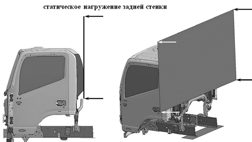
Рис. 12. Расчётная модель нагрузки для Испытания С по Правилам 29.02.
