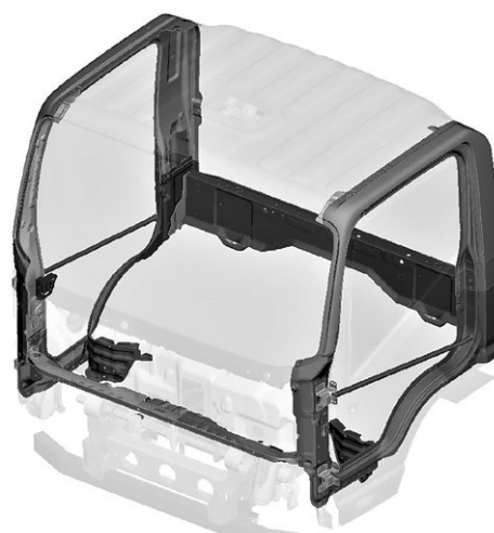
Рис. 23. Элементы каркаса кабины, изменённые и добавленные в Модель 2.
