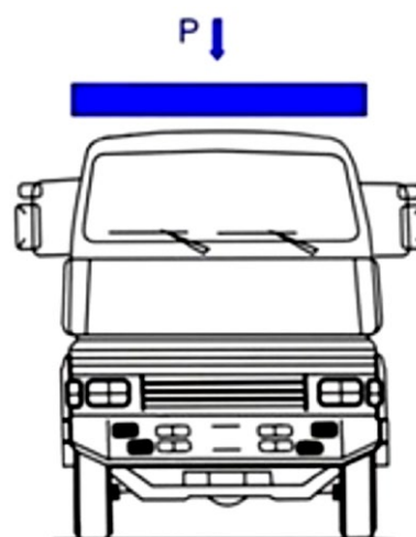
Рис. 2. Схема проведения Испытания В согласно Правилам 29.02. Fig. 2. Diagram of the Test B conducting according to the UNECE Regulation 29.02.
