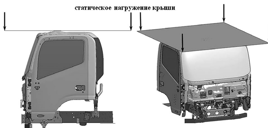
Рис. 11. Расчётная модель нагрузки для Испытания В по Правилам 29.02 и второго этапа Испытания С по Правилам 29.03.
