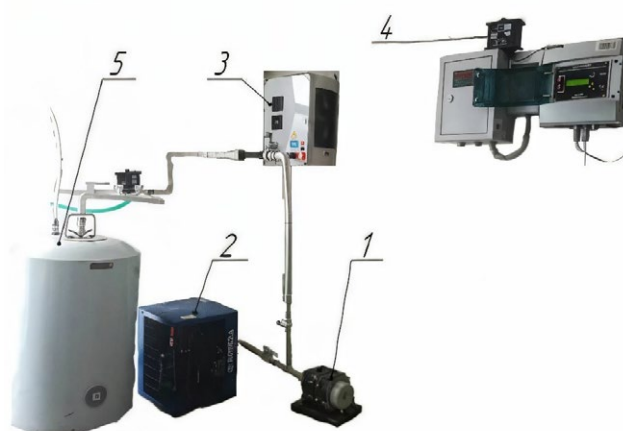
Рис. 1. Экспериментальная установка по озонированию посевного материала: 1 — компрессор; 2 — осушитель воздуха; 3 — озонатор; 4 — датчик Сигма-03; 5 — резервуар.
