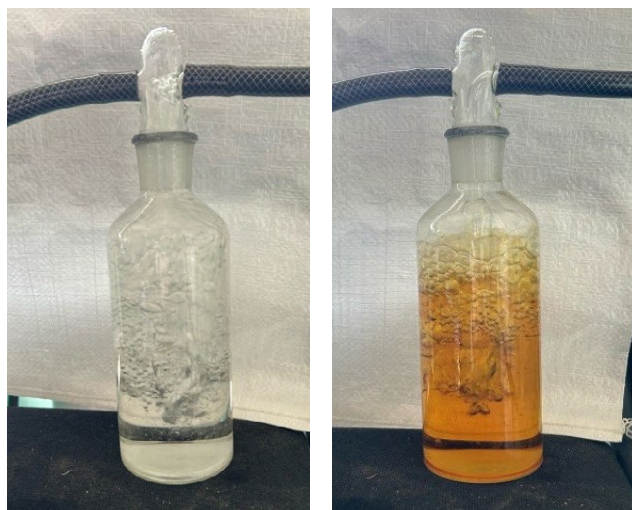
Рис. 3. Воздействие озонОВОздушной смеси на окрас раствора йодистого калия.
