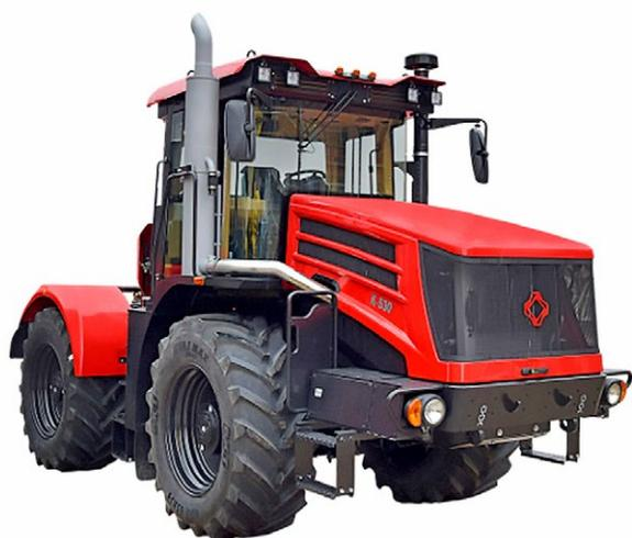
**Рис. 10.** Трактор с шарнирно-сочленённой рамой К-530Т.
