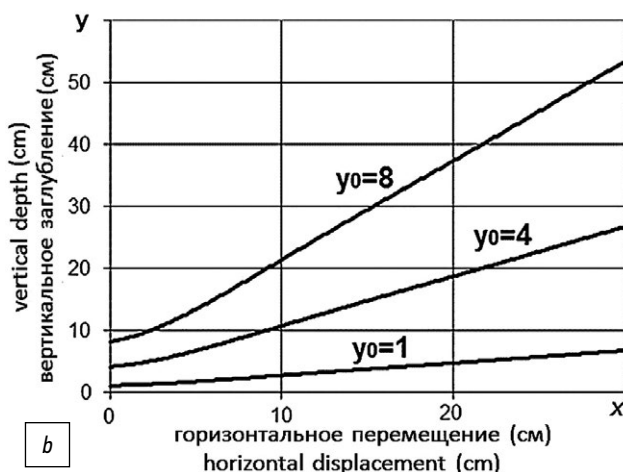
Рис. 4. Траектория y(x) движения штампа при разной а) — ширине b и б) — начальном погружении y_0 .
