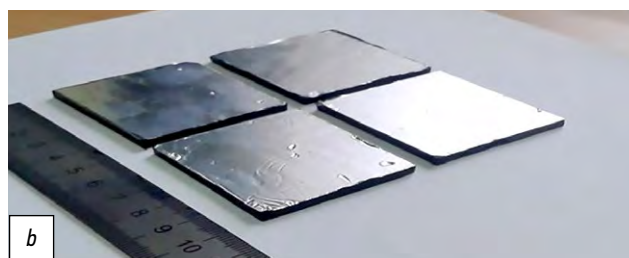
Рис. 1. Принципиальная схема электронагревательного полимерного композита: 1 — диэлектрическая оболочка; 2 — токосъёмник; 3 — функциональный материал нагревателя; 4 — токоподводящие проводники; b — общий вид плоских нагревателей.
