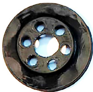
Рис. 1. Образец исследуемого резинотехнического изделия фильтра тонкой очистки топлива ЯМЗ-236, 238, 240.
