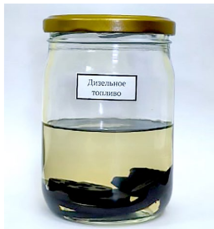
Рис. 2. Ремкомплект в дизельном топливе. Fig. 2. The repair kit in the diesel fuel.
