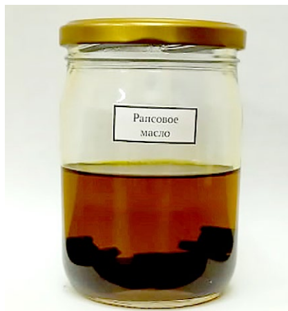
Рис. 3. Ремкомплект в рапсовом масле. Fig. 3. The repair kit in the rapeseed oil.
