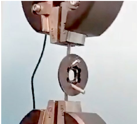
Рис. 5. Исследования ремкомплекта (резиновых изделий) фильтра тонкой очистки топлива ЯМЗ-236, 238, 240. Fig. 5. Studies of the repair kit (rubber technical products) of the fine fuel filter of the YaMZ 236, 238, 240 diesel engines.
