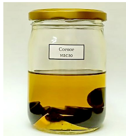
Рис. 4. Ремкомплект в соевом масле. Fig. 4. The repair kit in the soybean oil.
