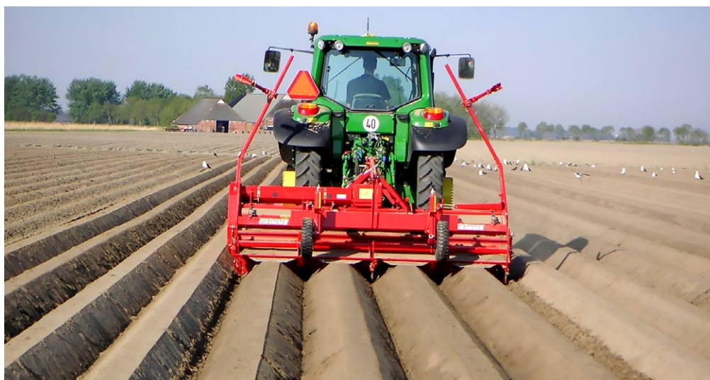
Рис. 1. Формирование гребней культиватором-гребнеобразователем с активными рабочими органами.
