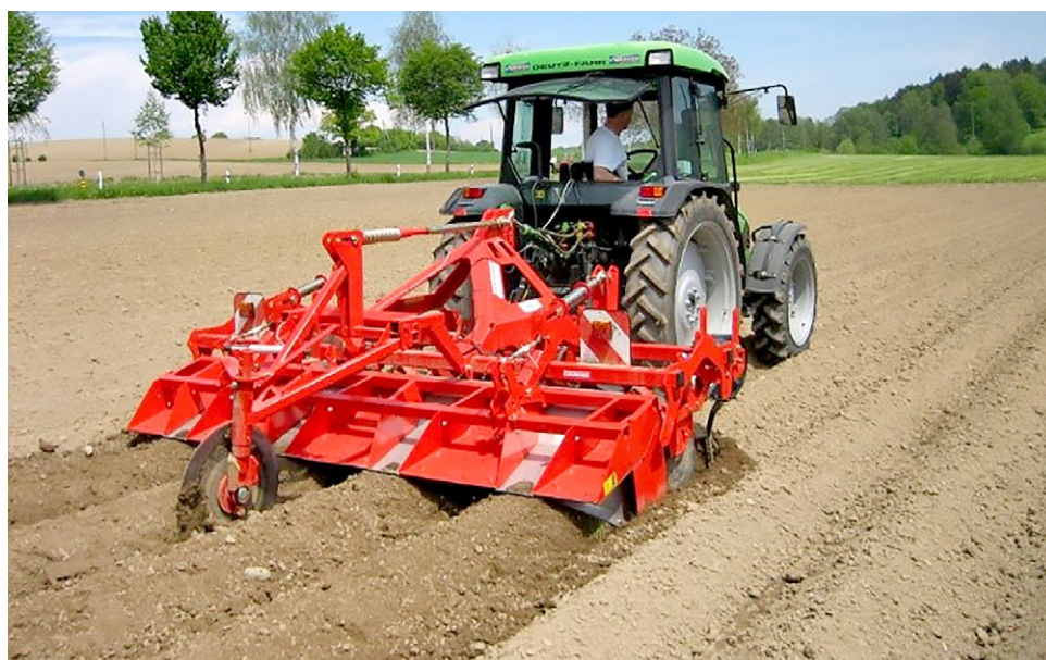
Рис. 2. Формирование гребней культиватором-гребнеобразователем с пассивными рабочими органами.
