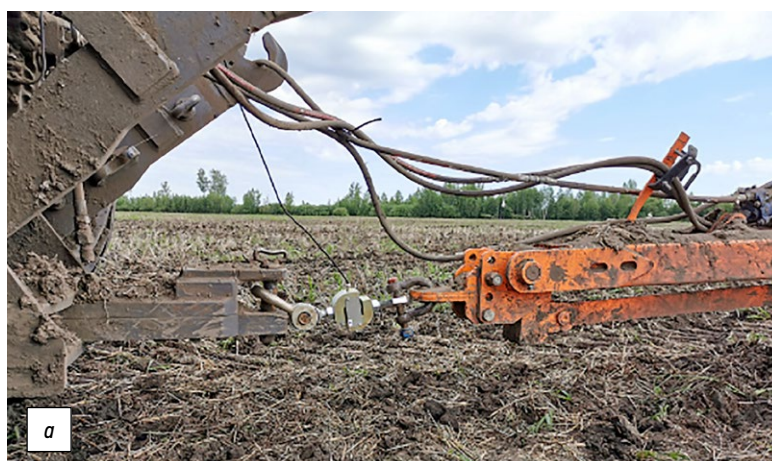
Рис. 8. Тензоизмерительное оборудование: а — тензовзвешивание 7 тс; б — измерительно-вычислительный комплекс МІС-200.
