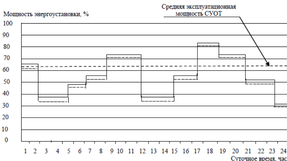
Рис. 1. Изменение электрической и тепловой нагрузки двигателя-генератора в течение суток (условный пример):
