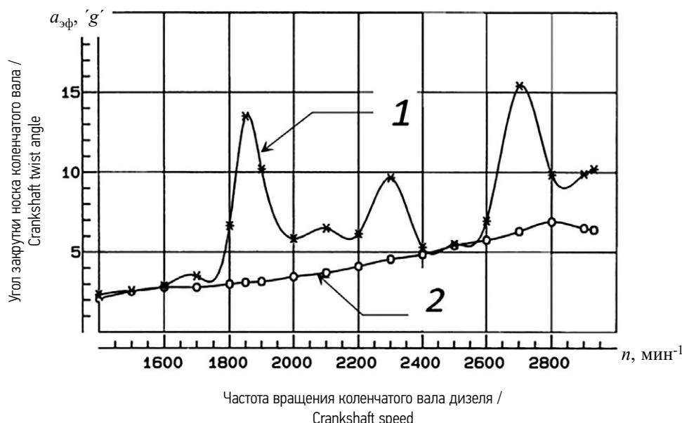
Рис. 1. Эффективность демпфирования вибраций стяжного болта передней коренной опоры дизеля 8ЧН 12/13: 1 — без демпфера крутильных колебаний; 2 — с демпфером.
