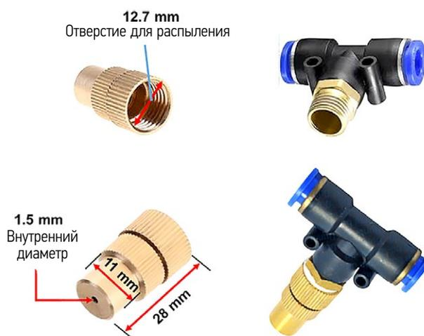
**Рис. 1.** Распылительная форсунка (с габаритами).
