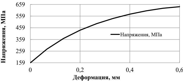
Рис. 1. Пример зависимости напряжений от деформаций при температуре +400^{\circ}\text{C} для нержавеющей стали 12ХН10Т (из библиотеки Ansys).
