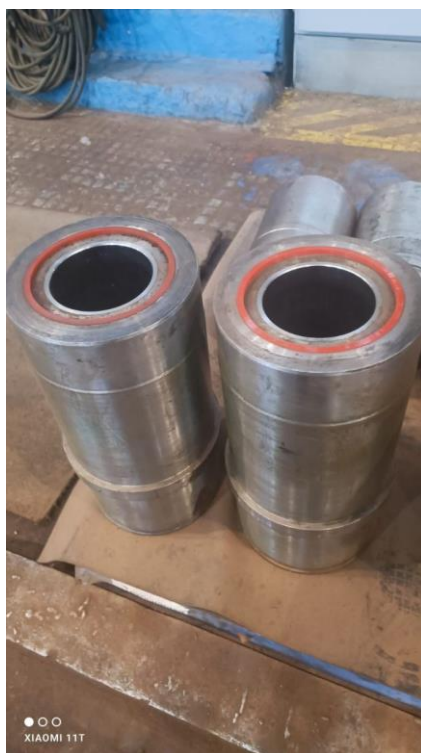
Рис. 1. Конструкция втулки с рабочей частью из чугуна.
