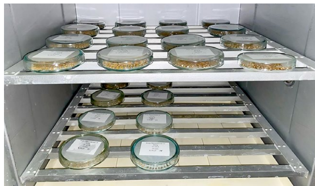
Рис. 4. Определение энергии прорастания и всхожести семян, обработанных низкочастотным электромагнитным воздействием. Fig. 4. Defining the germination energy of the seeds treated by low-frequency electromagnetic exposure.
