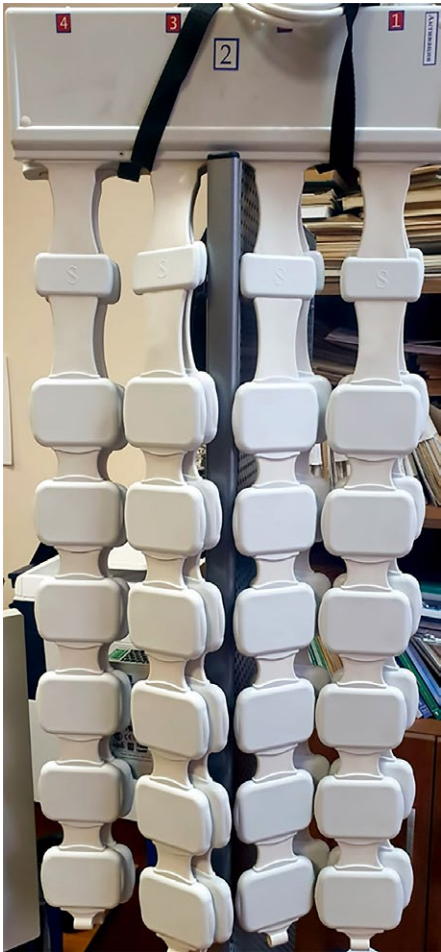
Рис. 2. Общий вид набора электромагнитных излучателей: 1 — блок управления; 2 — лента облучателей. Fig. 2. General view of bunch of the electromagnetic irradiators: 1 — a control unit, 2 — a band of irradiators.
