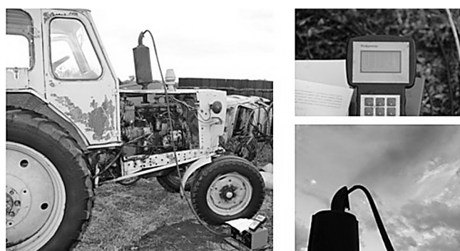
Рис. 2. Измерение дымности ОГ
