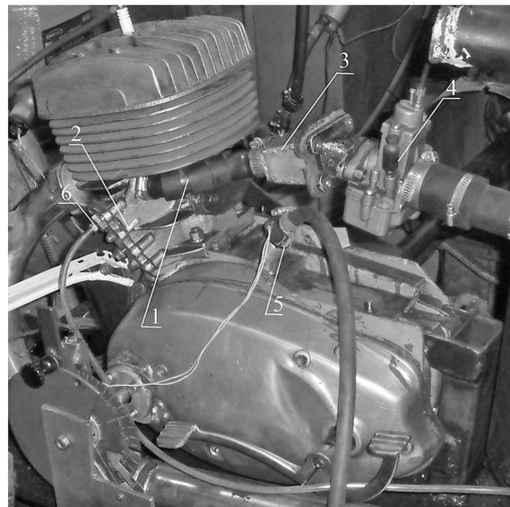
Рис. 6. Двухтактный двигатель с послойным смешением и впрыском бензина:
