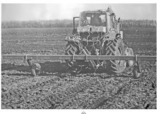
Рис. 4. Измерение энергозатрат на обработку почвы по следу колес (а) и сопротивления качению опорных колес культиватора (б)
