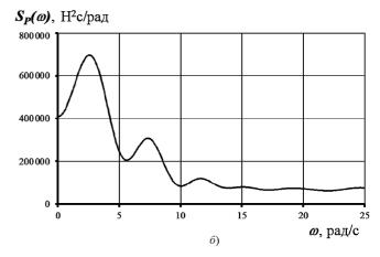
Рис. 5. Нормированная автокорреляционная функция (a) и спектральная плотность ( $\delta$ ) процесса изменения силы тяги на крюке трактора
