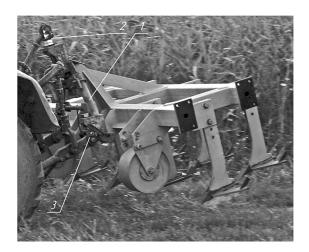
Рис. 1. Динамометрическая рама и тензодатчики:
