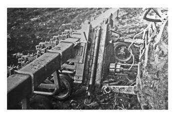
Рис. 3. Динамометрирование культиватора КРН-5,6
