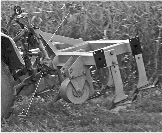
Рис. 1. Динамометрическая рама и тензодатчики:
