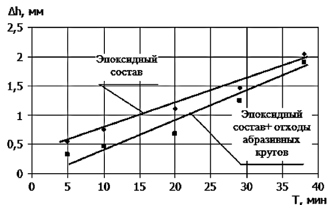
Рис. 1. Характер износа исследуемых материалов во времени при частоте вращения V = 1000 \text{ мин}^{-1}
