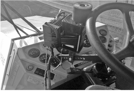
Рис. 4. Электромеханический привод подруливающего устройства при полевых испытаниях
