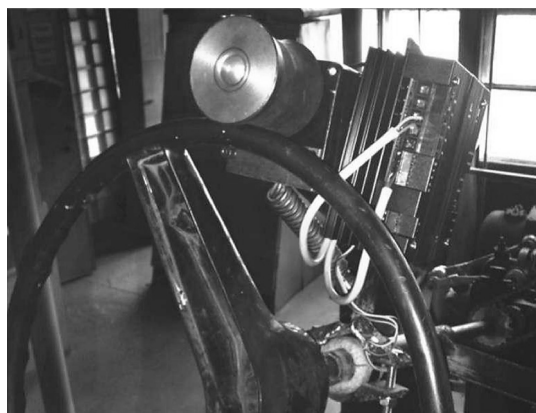
Рис. 1. Электромеханический привод подруливающего устройства при лабораторных испытаниях
