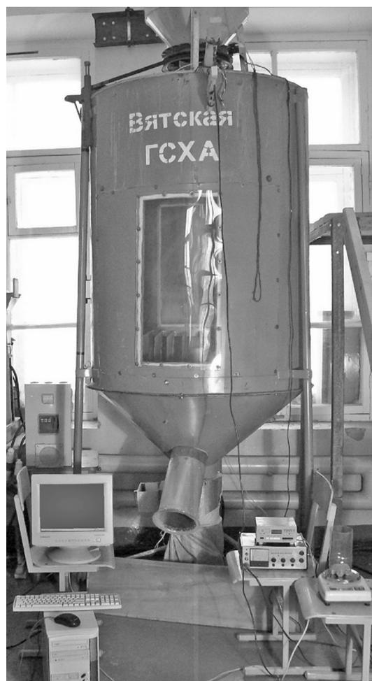
Рис. 1. Общий вид пневмосепаратора при проведении исследований датчика потерь зерна
