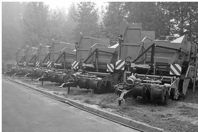
**Рис. 2. Двухрядные картофелеуборочные комбайны AVR 220BK Variant на заводе-изготовителе ЗАО "Колнаг" (г. Коломна)**
