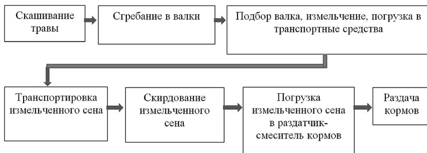
Рис. 2. Новая технология заготовки измельченного сена
