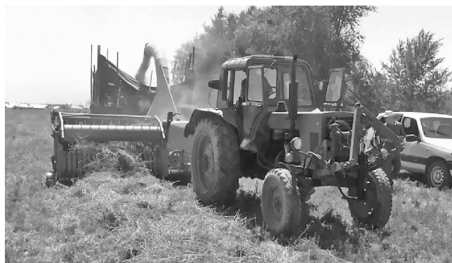
Рис. 5. Производственные испытания подборщика-измельчителя на люцерне влажностью 15,7 %
