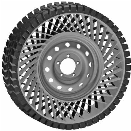
Рис. 7. Непневматическая шина с механической регулировкой жесткости
