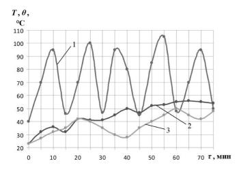
Рис. 3. Зависимости температуры агента сушки 1 и температуры зерна 2 от времени сушки, кривая 3 приведена по источнику [9]
