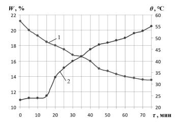
Рис. 2. Зависимости средней влажности зерна  $W\left( 1\right)$  и средней температуры зерна  $\theta\left( 2\right)$  от времени сушки  $\tau$
