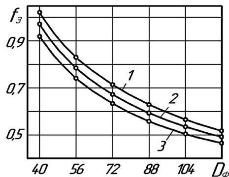
Рис. 4. Зависимость коэффициента защемления  $f_3$  от фиктивного диаметра ножа  $D_\phi$ :
